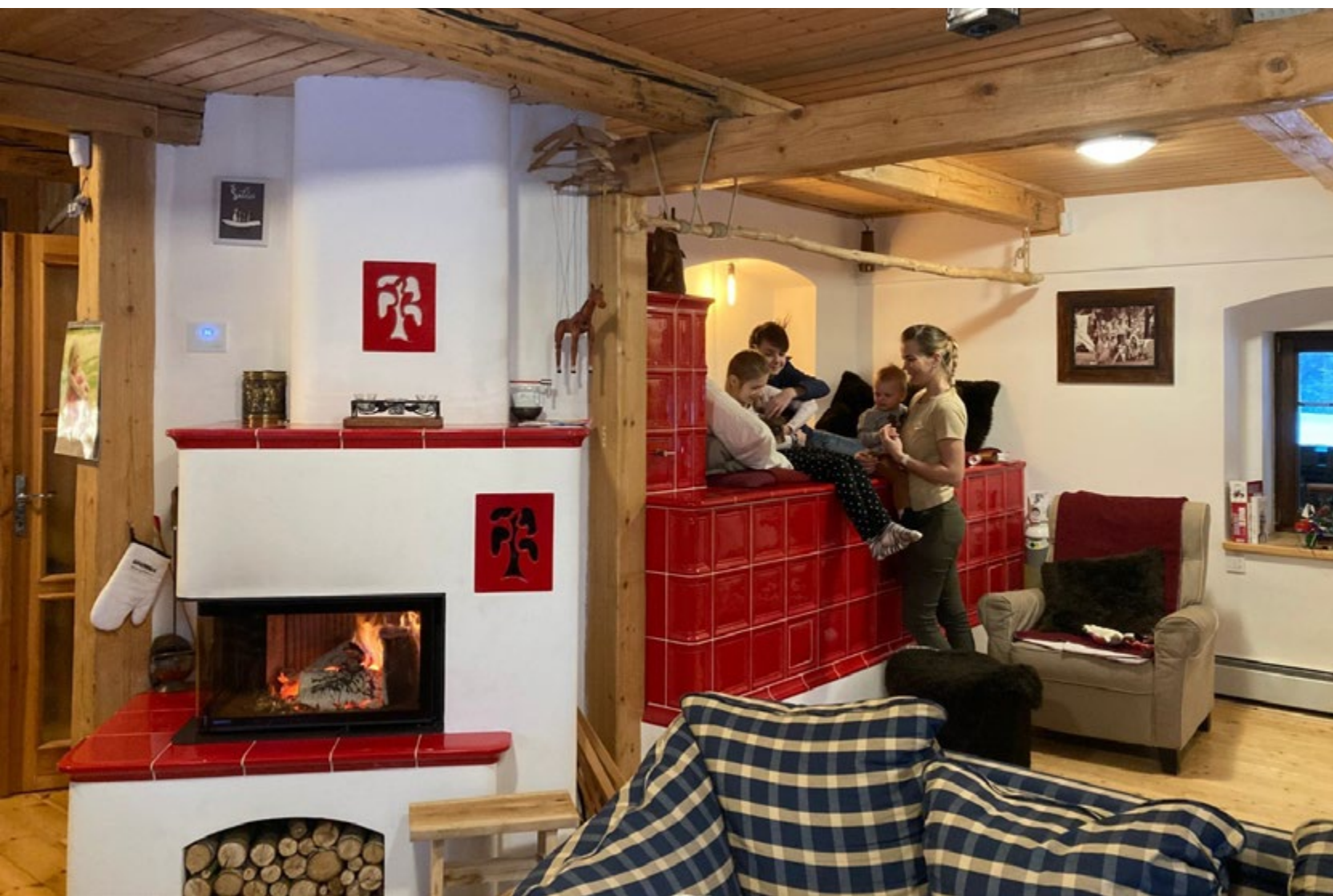
Rohová kamnová vložka Brunner HKD 10 s oblým rohovým prosklením poskytne jak okamžité teplo, tak mnoho energie, která zbude na akumulaci v tazích. Realizace a foto Kamnářství Koutecký
