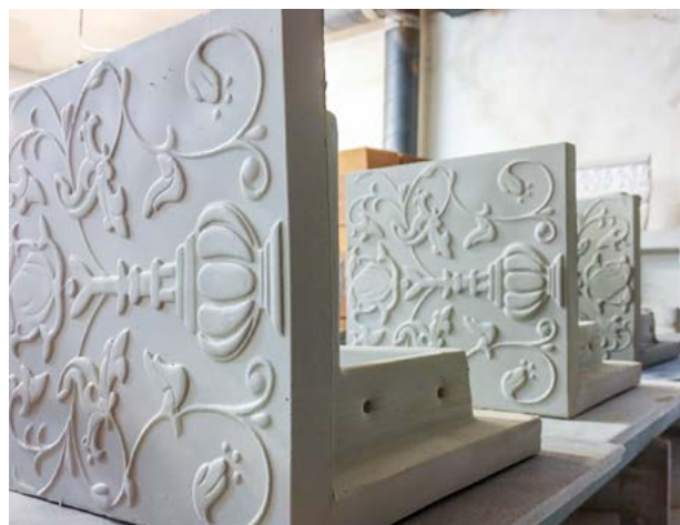
Rohový kachel s žebry a otvory pro kramlování- spojení kamnářským drátem
