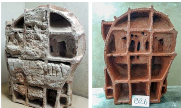
Odstraňování cementovo-maltových výplní
