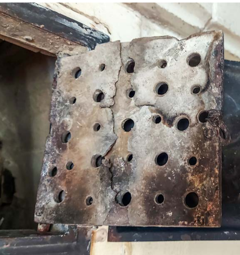
Žárem deformované a prasklé vnitřní křídlo příkládacích dvířek
