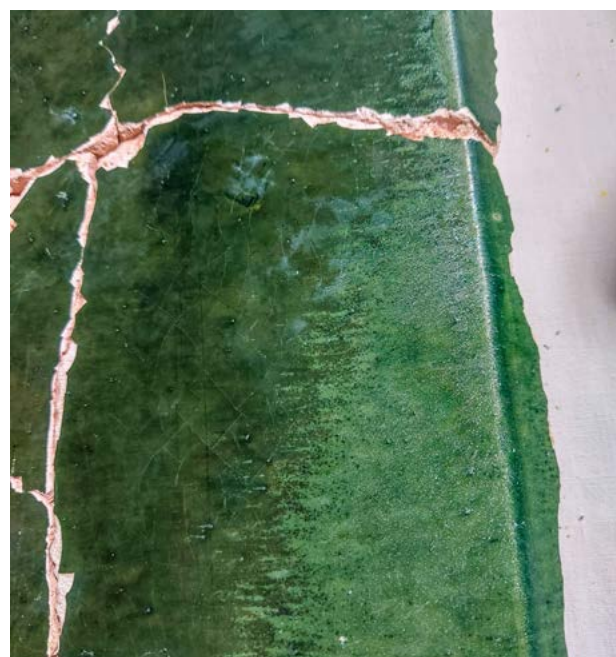
Obr. č. 4. Degradace glazury – matná část napravo byla dlouhodobě pod nánosy kamnářské hlíny.
