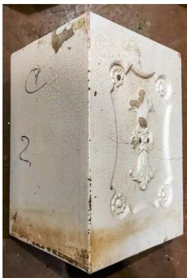
Obr. č. 3. Tzv. podglazurní znečištění – tmavé žlutohnědé neodstranitelné skvrny bývají nejvíce patrné na bílých kamnech. V tomto případě jsou také kachle nevhodně označeny černým lihovým fixem, který se může rozpít a vsáknout hluboko do keramiky, ze které poté nelze vymýt.
