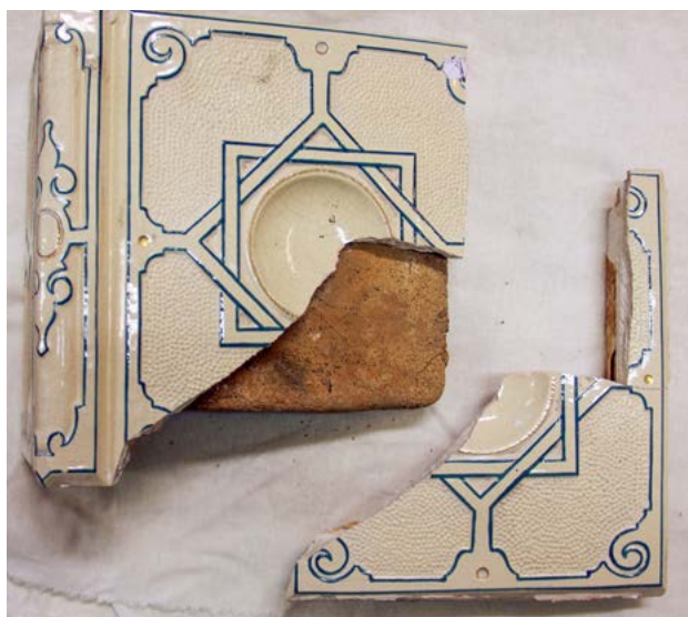
Obr. č. 2. Prasklý kachel v důsledku „bouchnutí“ v kamnech
