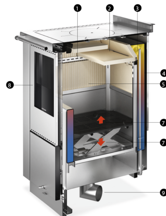
1 - přívod spalovacího vzduchu, 2 - horní tah, 3 - ochlazovací smyčka, 4 - teplovodní výměník, 5 - ohniště vyložené vysoce kvalitním šamotem, 6 - pohyblivý rošt, 7 - samočistící dvířka s trojitým prosklením, 8 - přívod externího vzduchu
